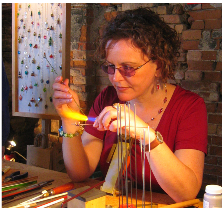
Mit viel Sorgfalt und Freude entsteht bei 1300 Grad eine Glasperle. Die Schutzbrille bewahrt vor Schäden an den Augen. Foto: Elmar Schuler
